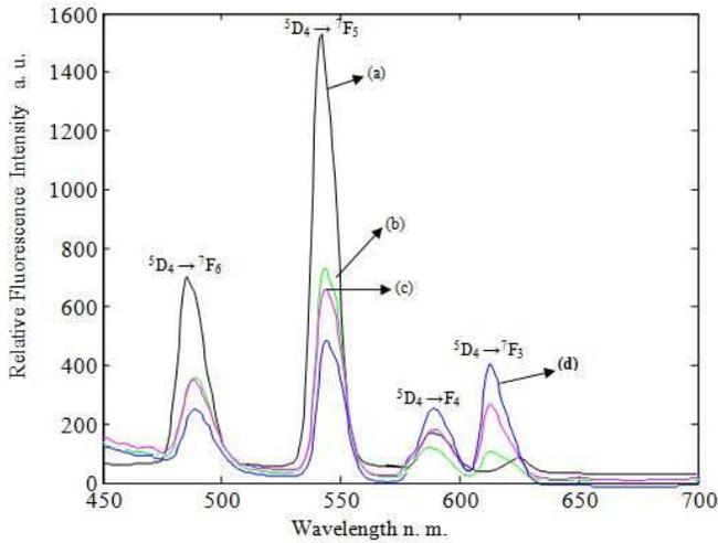
**Fig. 1. Fluorescence Spectra of (a) Tb<sup>3+</sup> (1.0 mole%) (b) Tb<sup>3+</sup> + Eu<sup>3+</sup> (0.25mole%) (c) Tb<sup>3+</sup> + Eu<sup>3+</sup> (0.5mole%) (d) Tb<sup>3+</sup> + Eu<sup>3+</sup> (1.0 mole%)**
